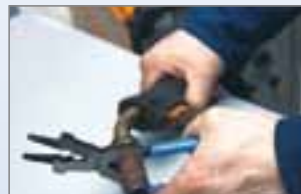
сваляне и инсталиране на газовата дюза
