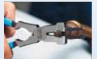
сваляне и инсталиране на контактната дюза
