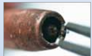
отрязване и издърпване на телта отвън
