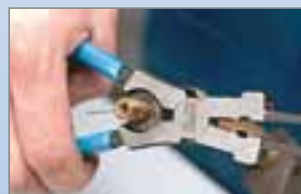
завиване и отвиване на ограничителния пръстен
